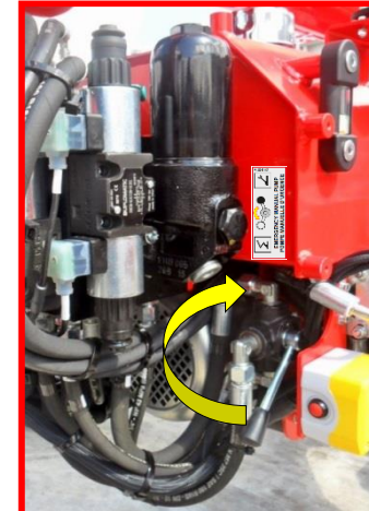
Afbeelding 25: hendel handpomp op stand herstel stempelpoten.
