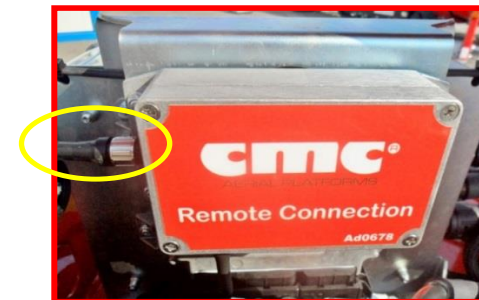
Afbeelding 88: kastje voor verbinding op afstand.
