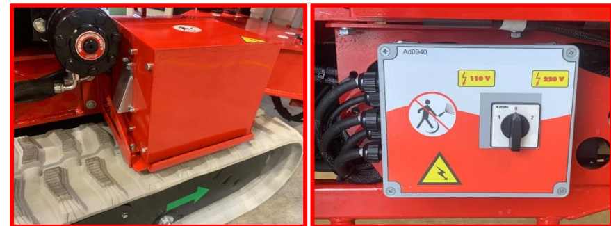
Afbeelding 7a: dynamo en keuzeschakelaar.
